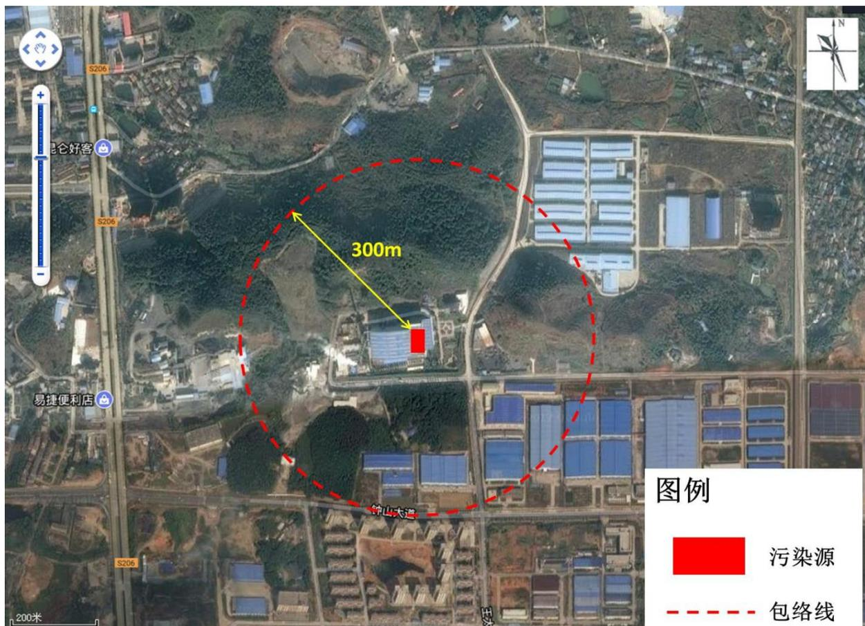
图 3.5-8 瀚蓝（黄石）固废处理有限公司卫生防护距离示意图
